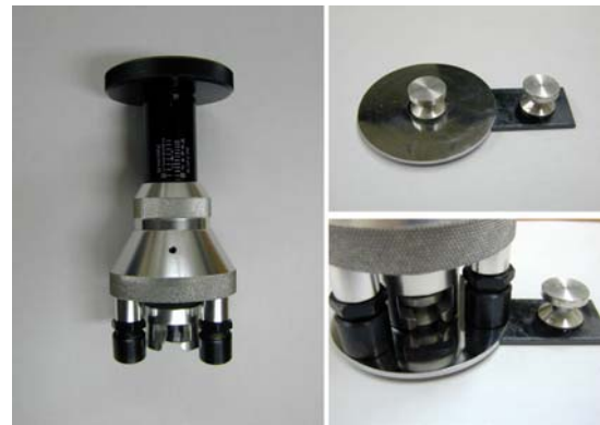
図3 試験機(左)、治具(右上)、剥離試験(右下)
